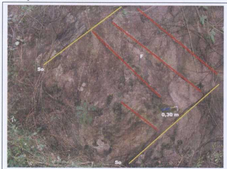
Fig. 85: Banco de aproximadamente 2 m de espesor, de calizas en facies rojas, donde se observa la red de fracturación perpendicular a la estratificación (E-21)
