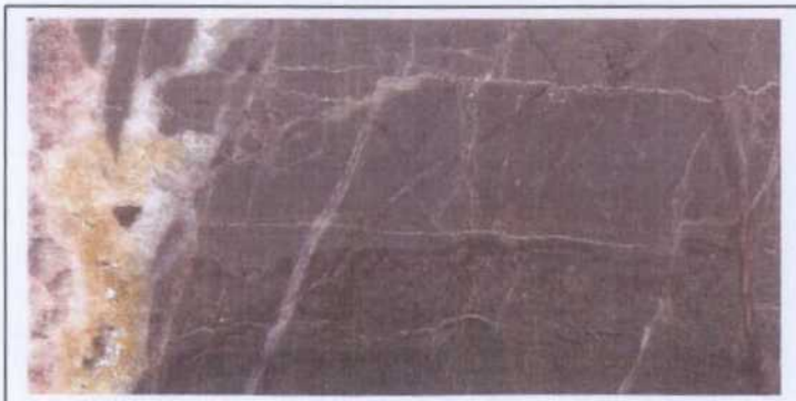
Fig. 77: Detalle de la muestra pulida correspondiente a la E-1, donde se observa el bandeo gris-rojo y las abundantes vetas de calcita
