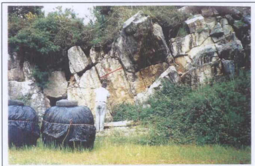
Fig. 70: Detalle del espesor de los bancos y de la red de fracturación en la E-4
