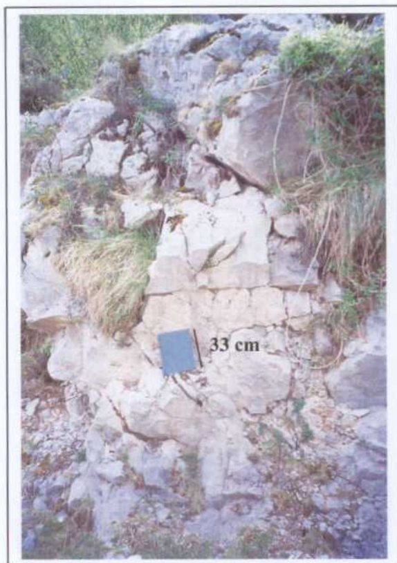
Fig. 169: Aspecto del afloramiento situado en la E-35, de apariencia ruiniforme y densamente fracturado
